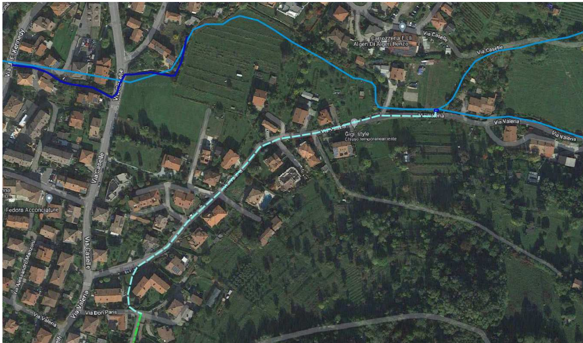
Fig.5.12 – T.Scapla: ipotesi di tracciato del collegamento (linea azzurra tratteggiata) tra t. Scapla e canale di gronda esistente (da “studio Barbero 2022”)
